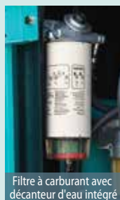
Préfiltre avec décanter d'eau intégré
