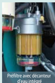
Filtre à carburant avec décanter d'eau intégré
