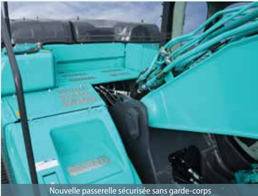
Nouvelle passerelle sécurisée sans garde-corps
